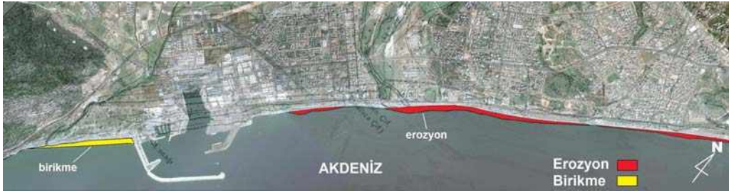
Şekil 8. 1934 ve 2010 yıllarına ait kıyı çizgilerinin karşılaştırması. Figure 8. Comparison of shorelines of 1934 and 2010 years.
